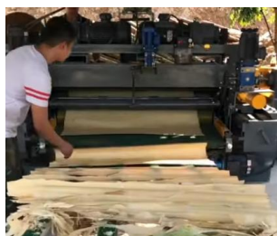
Bóc gỗ: gỗ tròn được bóc thành các tấm mỏng, được gọi là ván lạng (veneer)
