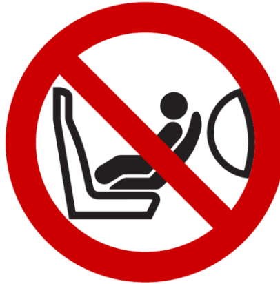
Hình 2 - Ký tự tượng hình ISO 2575:2004 - Z.01 được sử dụng cùng với vòng tròn có đường kính ít nhất 38 mm
