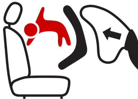
Hình 3 - Ký tự tượng hình thể hiện nguy cơ khi túi khí bung có kích thước bề rộng nhỏ nhất 40 mm, chiều cao nhỏ nhất 28 mm
