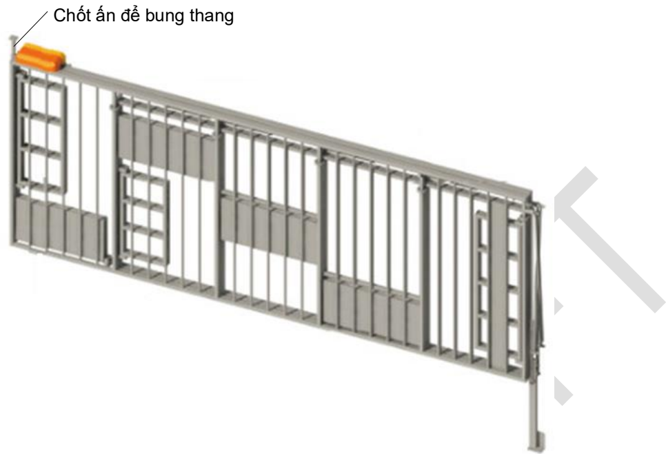
Hình A.19 – Ví dụ minh họa thang thoát nạn khẩn cấp tích hợp lan can tự hạ ở mặt ngoài nhà (trạng thái đóng của một phân đoạn thang trong phạm vi 1 tầng)
