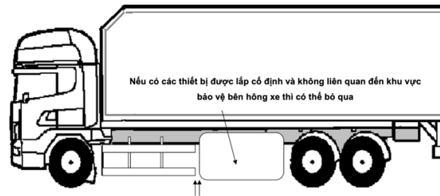
Khoảng hở lớn nhất từ mép trên của thiết bị tới điểm cuối của rào chắn ngang xe
