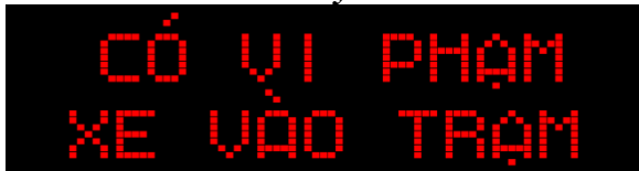
Hình 10. Biển VMS trên giá long môn thứ ba khi không đọc được biển số
