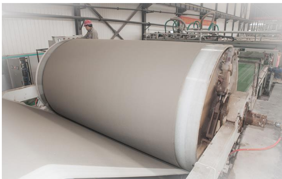
Hình 6. Dây chuyền sản xuất tấm xi măng sợi theo công nghệ flow-on
